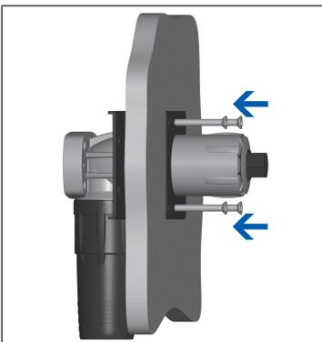
5. Die mitgelieferten Selbstbohrschrauben durch die Löcher der Halteplatte in die Gipsplatte und die Halteplatte einschrauben.
