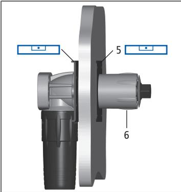
4. Die Befestigungsplatte **(5)** mit der Schutzhülse **(6)** an die Gipsplatte klemmen und parallel zur Halteplatte ausrichten.
