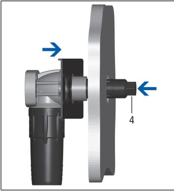
3. Den Bau- und Abpresszapfen **(4)** (85090) in die Dose einschrauben und von hinten durch das Loch in der Gipsplatte stecken.
