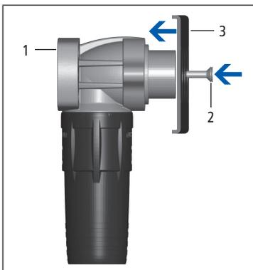
2. Die Dose (**1**) mit den beiliegenden Kunststoffschrauben (**2**) an der Halteplatte (**3**) (85060) befestigen.
