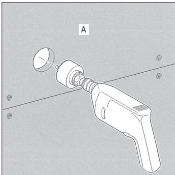
1. Mit einem Kronenbohrer auf Fadenkreuz ein Loch  $\varnothing$  33 mm in die Gipsplatte (**A**) bohren.
