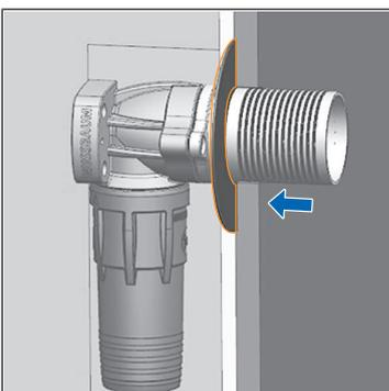
2. Die Optiflex-Dose einmauern und danach die Dichtscheibe 85124 über die Abdichtungsverlängerung schieben.
