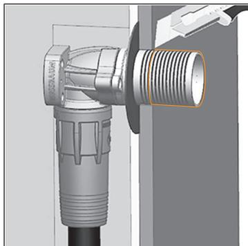
3. Die Wand abdichten und verfliesen und danach die Abdichtungsverlängerung mithilfe eines Messers bündig zur Wandoberfläche abschneiden.
