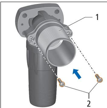
1. Die Abdichtungsverlängerung **(1)** auf die Optiflex-Dose legen und mit den mitgelieferten Linsenkopfschrauben **(2)** an der Dose befestigen.
