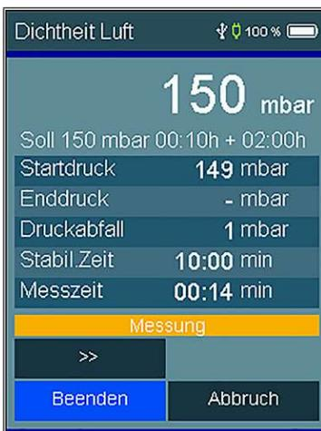
Bei Dichtheitsprüfungen wird zusätzlich die Stabilisierungszeit angezeigt.
