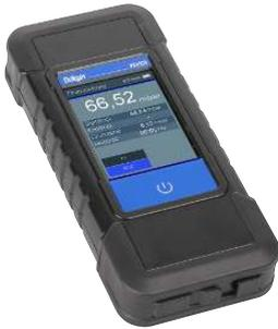
**83191** - Druckmessgeräte-Set PX4500, für Dichtheits- und Festigkeitsprüfungen
