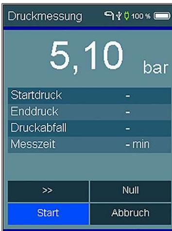
Bei Druckmessungen und Dichtheitsprüfungen wird der Startdruck, der Enddruck, der Druckabfall und die Messzeit angezeigt.
