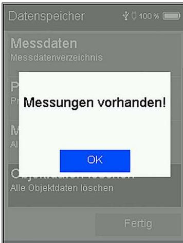
In der Einschaltphase und während des Messbetriebs prüft das Messgerät die ordnungsgemäße Funktion. Warnhinweise und Fehlermeldungen werden nach der Startphase oder während der normalen Funktion angezeigt.
