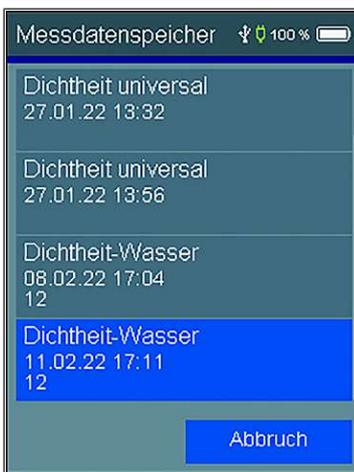
Ohne Objektzuordnung wird die Messung nur mit Datum und Uhrzeit gespeichert. Ist die Messung einem Objekt zugeordnet, wird zusätzlich die Objekt Nummer angezeigt.
