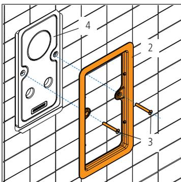
2. Den Grundrahmen **(2)** mit den mitgelieferten M5-Schrauben **(3)** an die verbaute Unterputz-Armaturenbox **(4)** schrauben. Die Schrauben handfest anziehen. Bei übermässiger Beanspruchung können die Gewindebolzen beschädigt werden.
