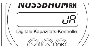
1. Falls die Kartusche gewechselt wurde, mit den Pfeiltasten und [JA] auswählen. Die Taste 3 Sekunden lang drücken, um die Eingabe zu bestätigen.
