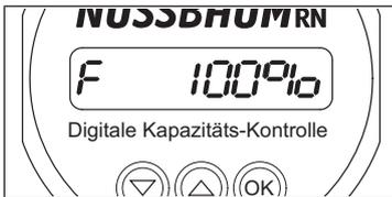
2. Um die Restkapazität in % abzurufen, die Taste **OK** drücken. Die Anzeige wechselt nach wenigen Sekunden zurück zur Restkapazität in Litern.
