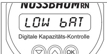
Wenn die Batterie gewechselt werden muss, wird die Meldung [LOW bAT] angezeigt (☞ «Batterie wechseln», Seite 10).
