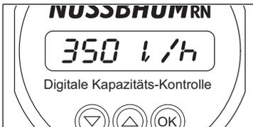
Während der Befüllung zeigt das Display den aktuellen Volumenstrom an.
